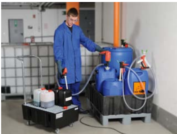
COMBIFLUX – Abfüllen verschiedener Fluide mit mehreren Pumpen und einem kabelgebundenen Motor FEM 3070.
